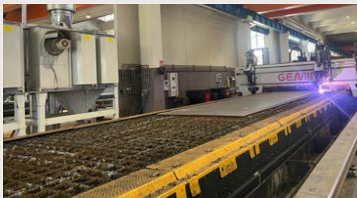
▲ Linea GEMINI in lavorazione con testa plasma "bevel" per lamiere di grandi dimensioni
