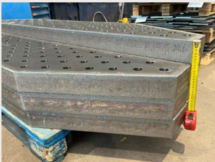
◀ ▶ Lamiere con varie lavorazioni di taglio termico (forature, cianfrinature e smussature) effettuate con gli impianti FICEP
