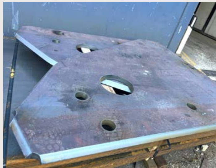
◀ ▶ Lamiere con varie lavorazioni di taglio termico (forature, cianfrinature e smussature) effettuate con gli impianti FICEP
